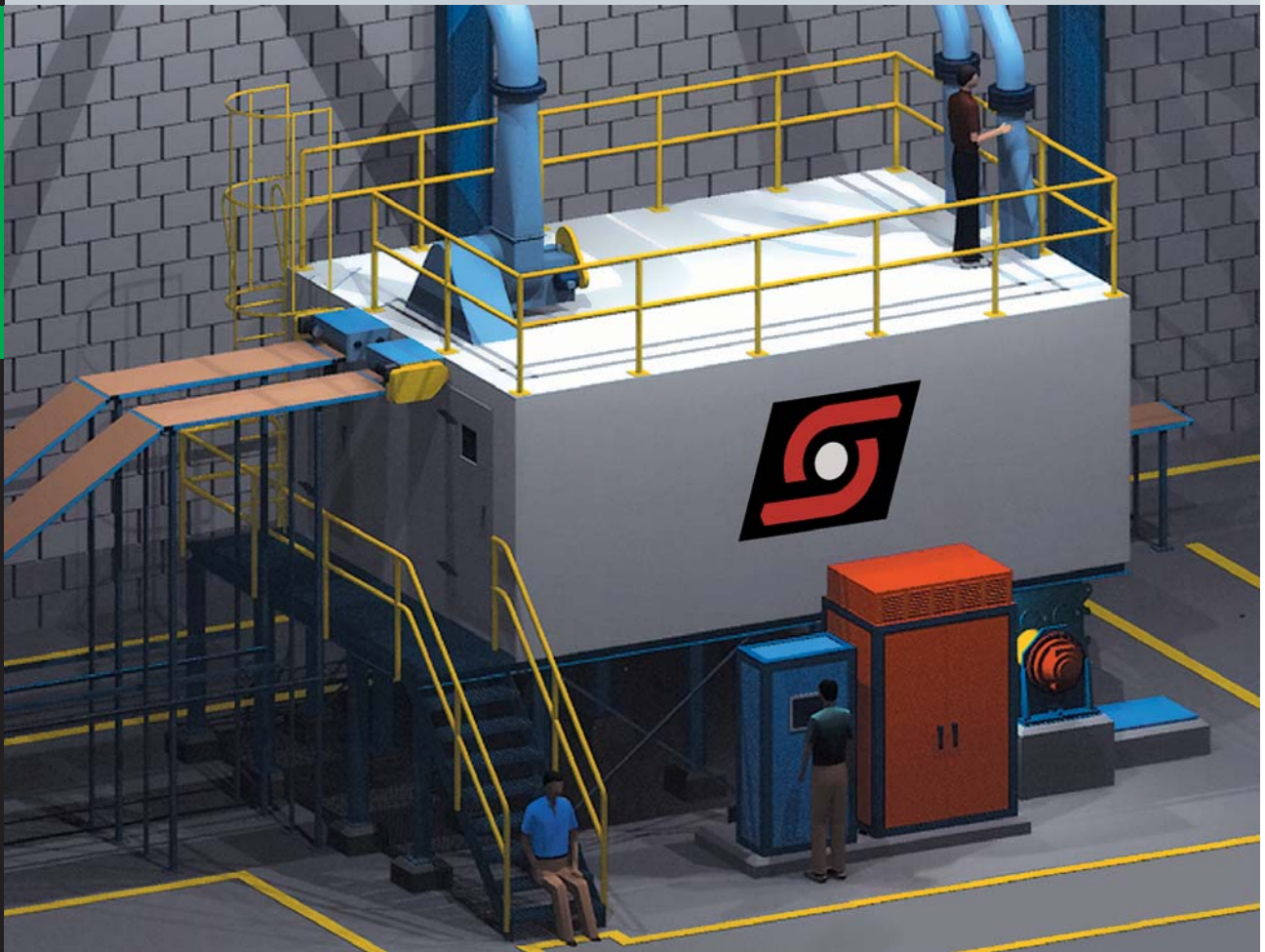
Camera di refrigerazione • Freezing Chamber
